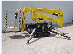
Semovente articolata su cingoli operante su stabilizzatori
