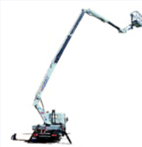
Semovente telescopica con braccetto articolato su cingoli operante su stabilizzatori
